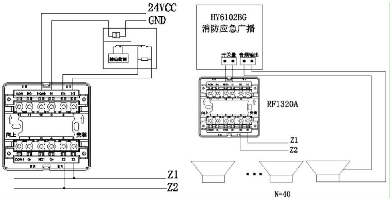
控制现场设备接线示意图
